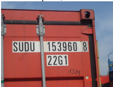
Código internacional de identificação de contêineres. A normatização internacional das caixas metálicas, viabilizou sua modularidade e intercambiabilidade, Fotos do autor.
