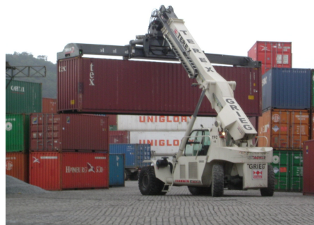
Guindaste tipo Stacker, movimenta contêiner em pátio de estocagem. Necessidades de grandes espaços e sistemas de informação para gerenciamento dos terminais especializados.
